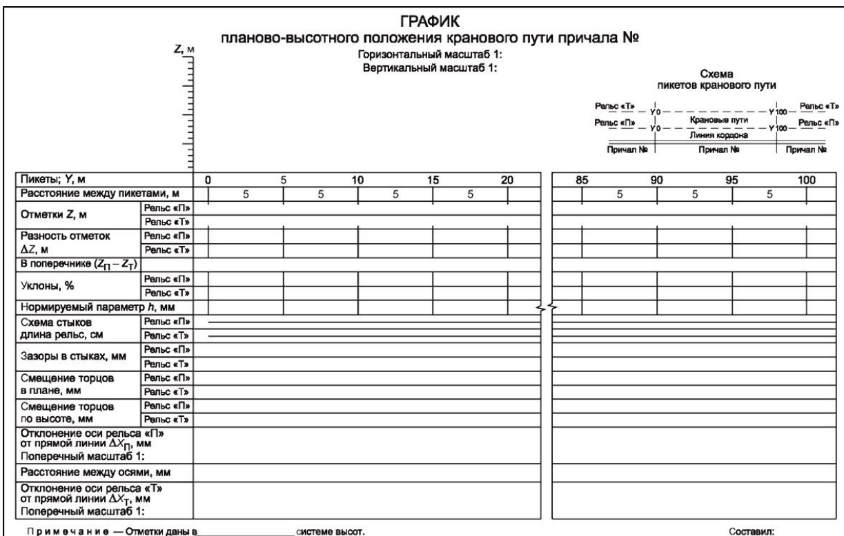
Рисунок 12.2 - График планово-высотного положения кранового пути причала
