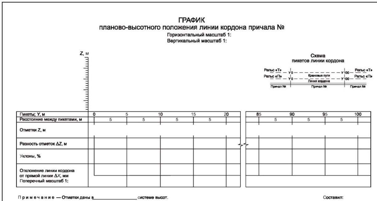
Рисунок 12.1 - График планово-высотного положения линии кордона причала
